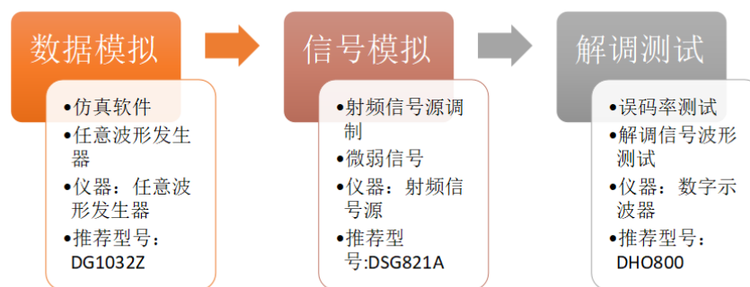
图 4.3 RIGOL 接收灵敏度测试方案
