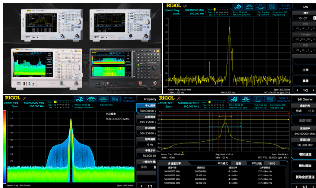
图 4.1 RIGOL 频谱仪扫频，实时和高级测量功能
