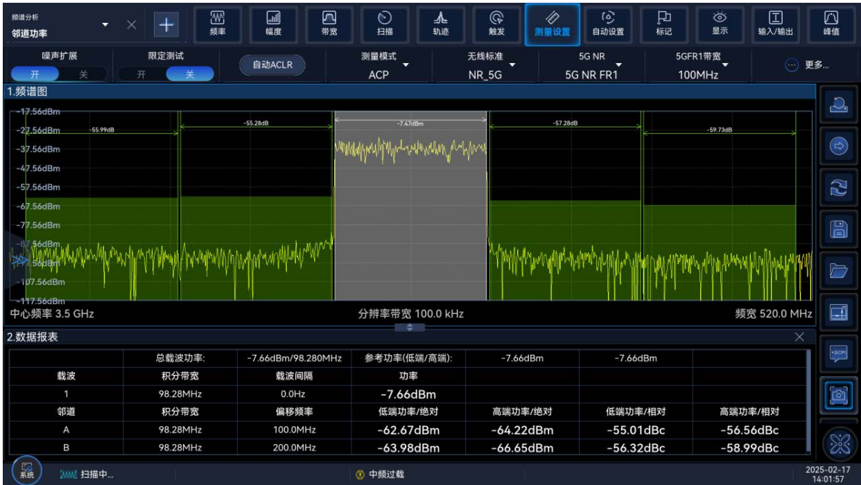
ACLR 测试结果 ( 5G NR FR1,100MHz,256QAM,30kHz SCS , 3.5GHz )
