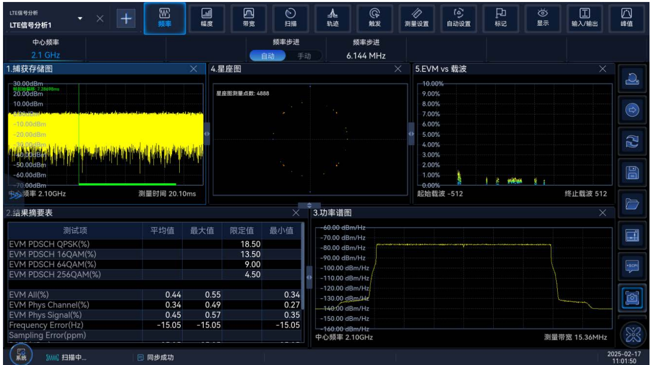
EVM 测试结果 (LTE, 10MHz LTE E-TM3.1, 2.1GHz)
