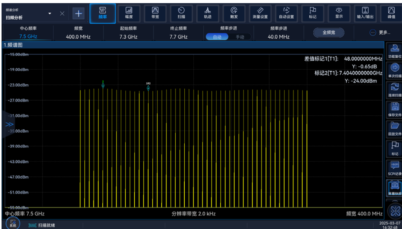
1434BV 240MHz 调制带宽多音信号频谱 ( 7.5GHz )
