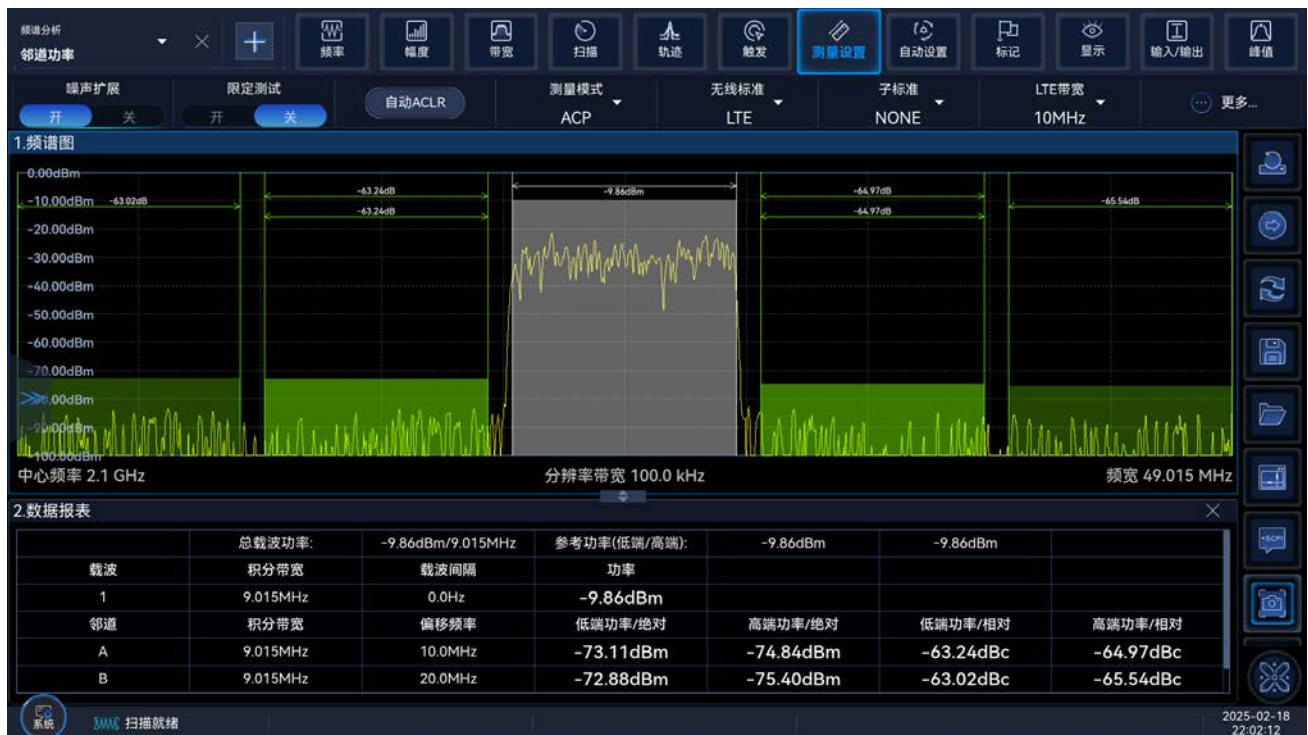
ACLR 测试结果 (LTE, 10MHz LTE E-TM3.1, 2.1GHz)
