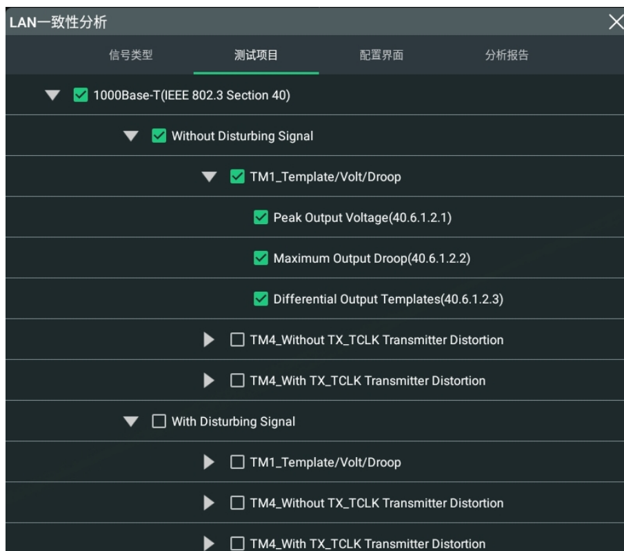
图 18.5 1000Base-T 信号测试项目
