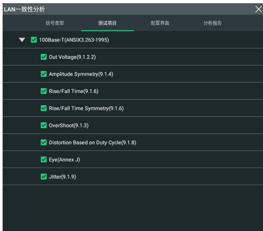
图 18.4 100Base-T 信号测试项目
