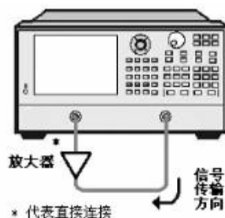
图 8.22 反向隔离测量连接
