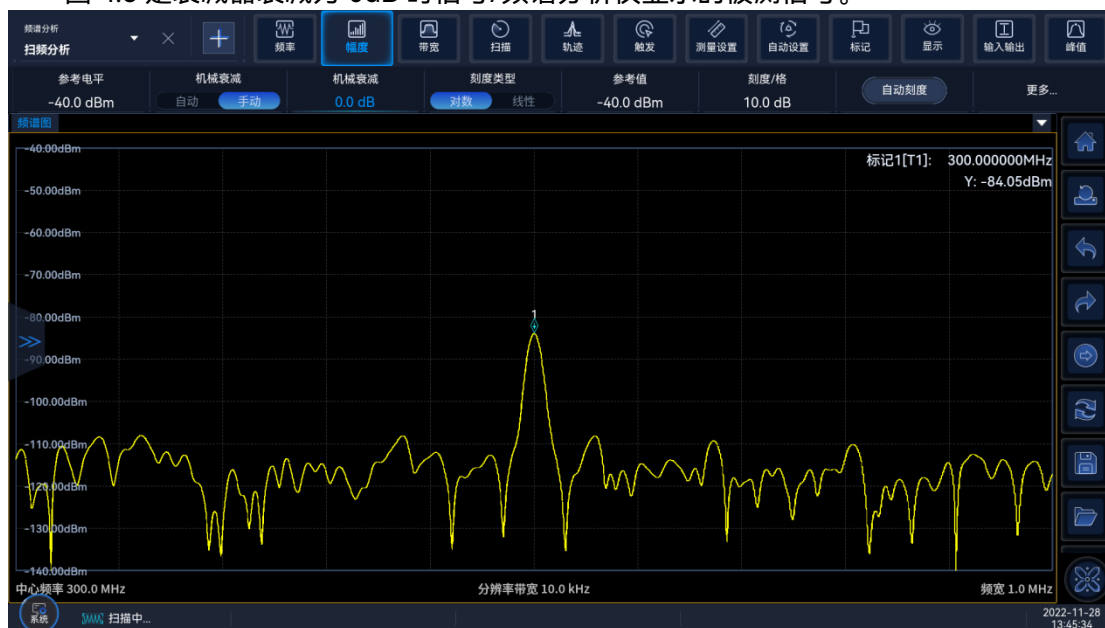
图 4.6 衰减器 0dB 时的小信号
