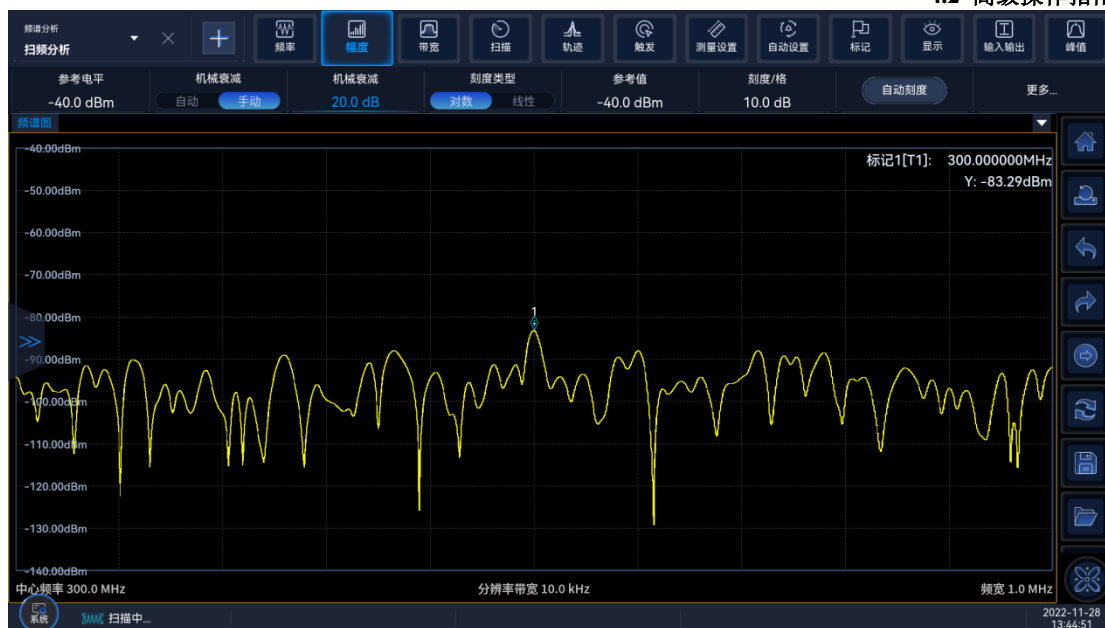
图 4.5 衰减器 20dB 时的小信号
