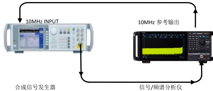
图 7.4 标记计数测试示意图
