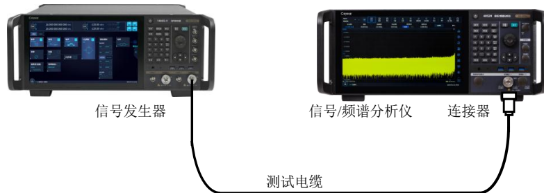
图 4.22 谐波失真测量连接设置
