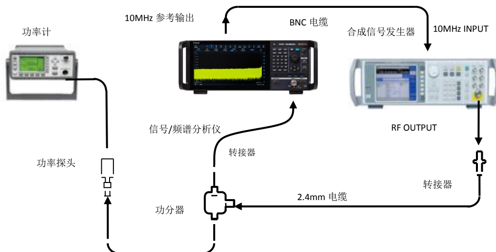
图 7.8 频率响应测试示意图 (50MHz ~ 50GHz)
