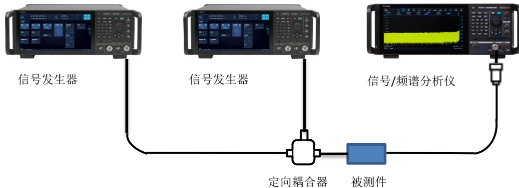
图 4.24 三阶交调测量连接设置
