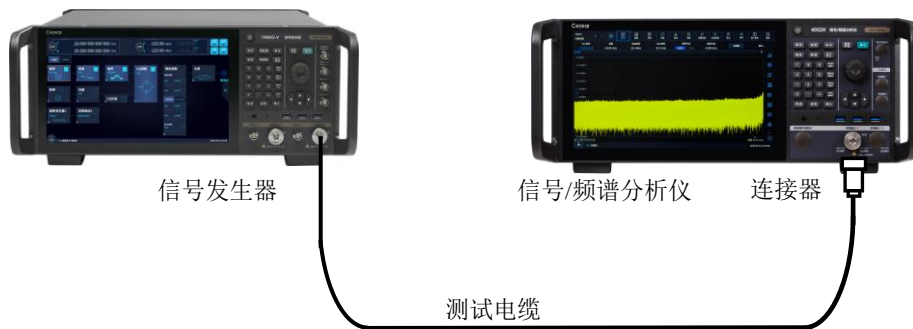
图 4.20 突发功率测量连接设置
