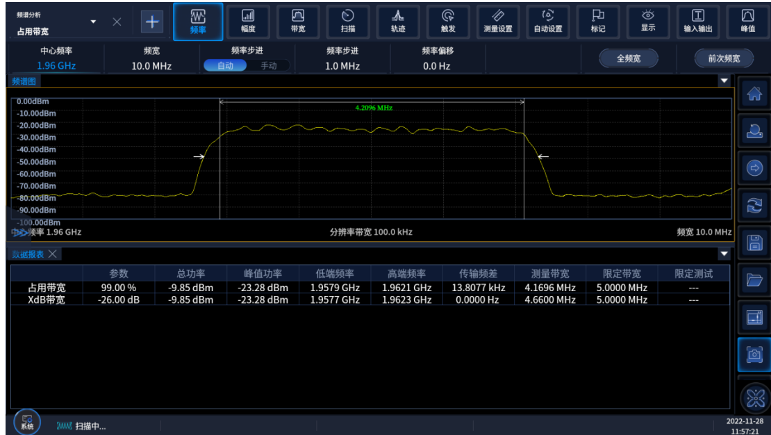
图 4.11 占用带宽测量结果
