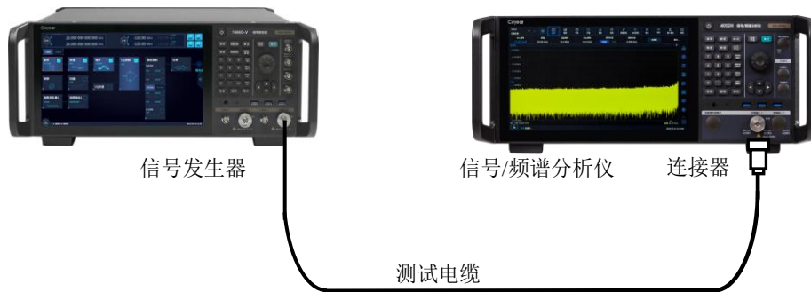
图 4.26 杂散发射测量连接设置
