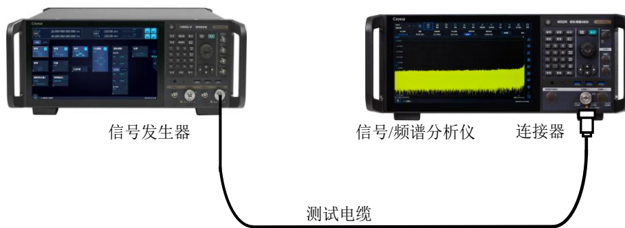
图 4.28 频谱发射模板测量连接设置
