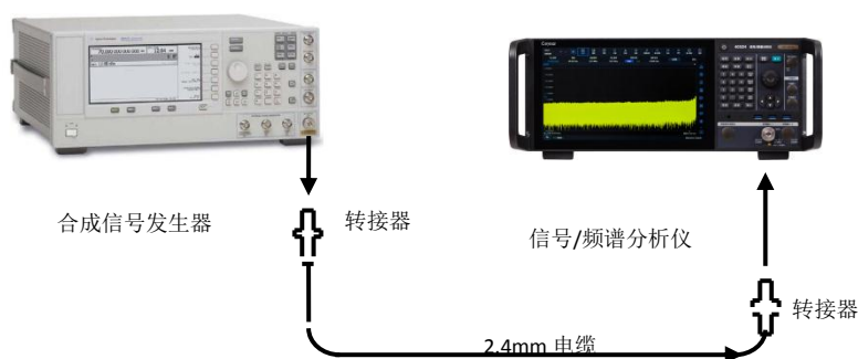
图7.17 相位噪声测试示意图
