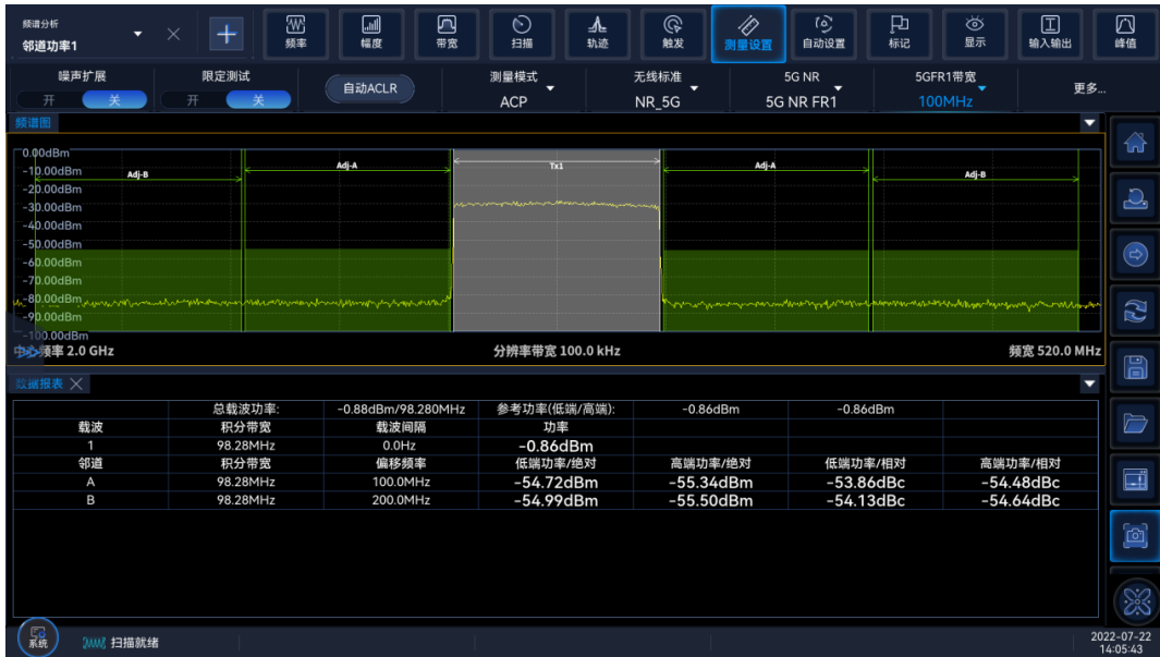
2GHz 载波 5G NR ACPR 实测结果
