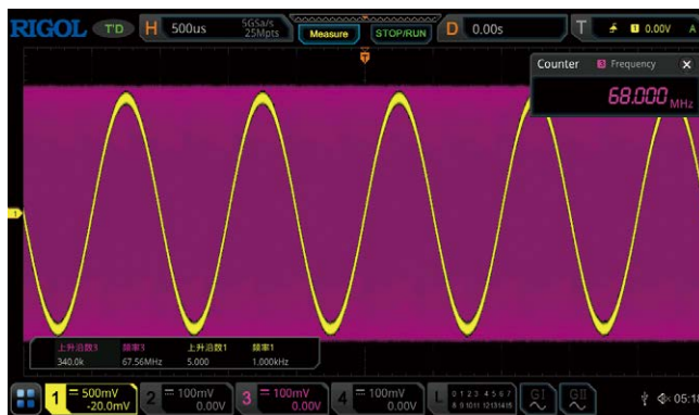
同时观察并准确测量两路频率相差很大的信号，全内存硬件测量可以在具有340k个上升沿的波形中测得准确的频率值
