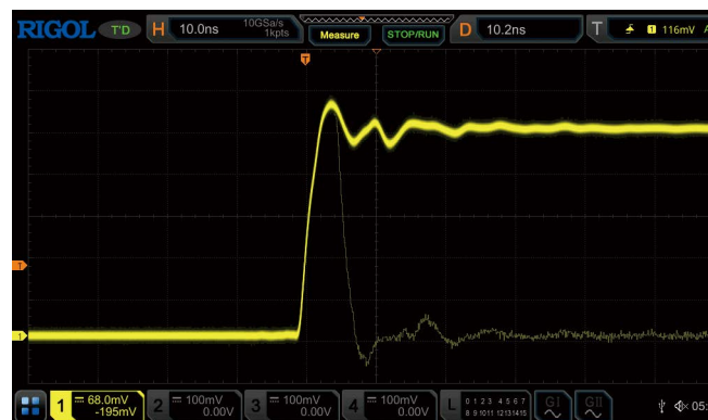
高刷新率模式下捕获偶发异常信号
