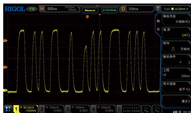
欠幅脉冲触发可以帮助捕捉脉冲序列中的矮脉冲信号
