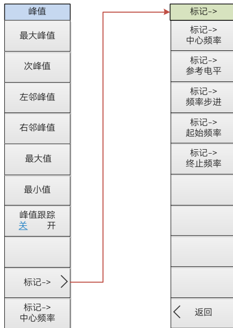
图 10.8 实时频谱模式峰值菜单结构框图
