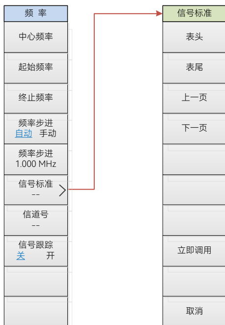
图 4.29 频谱分析模式频率菜单结构框图
