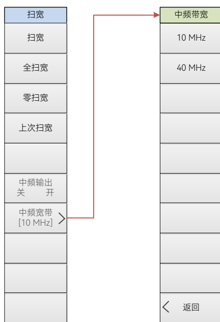
图 4.30 频谱分析模式扫宽菜单结构框图
