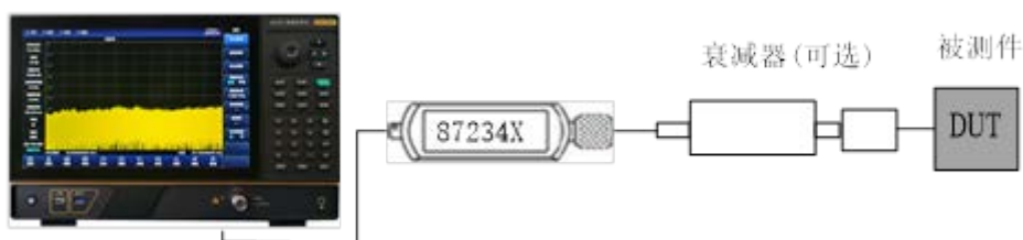
图 11.1 功率测量结构图
