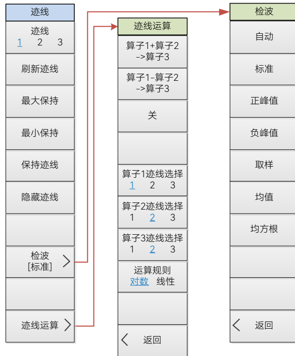
图 4.36 频谱分析模式迹线菜单结构框图
