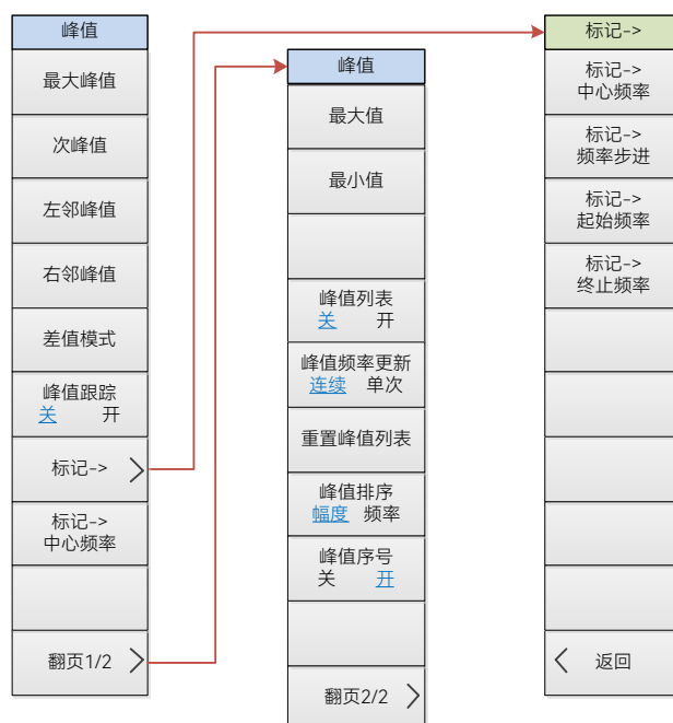
图 4.34 频谱分析模式峰值菜单结构框图
