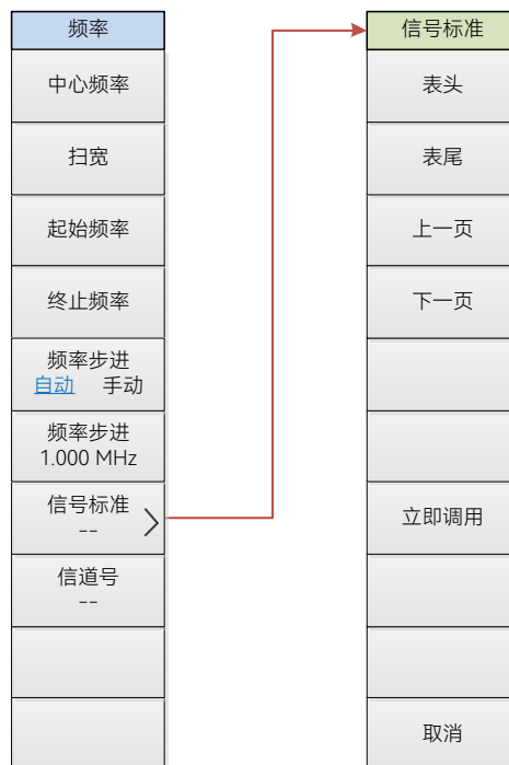
图 6.2 解调分析模式频率菜单结构框图
