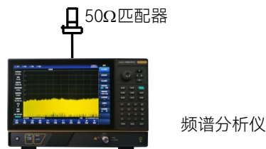
图 15.14 剩余响应测试设置
