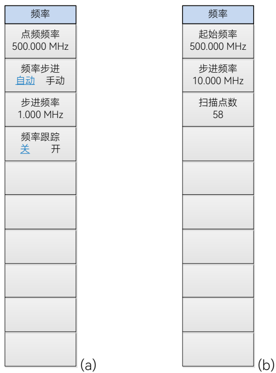
图 9.4 场强测量模式频率菜单结构框图: (a)点频测量; (b)频率测量
