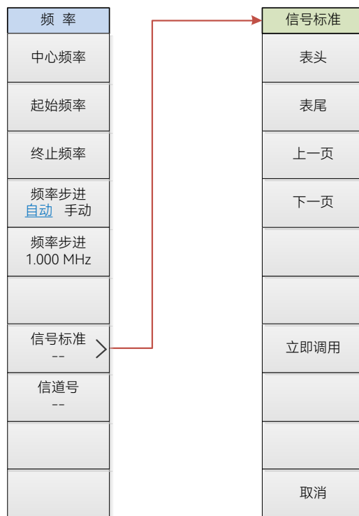
图 5.3 干扰分析模式频率菜单结构框图
