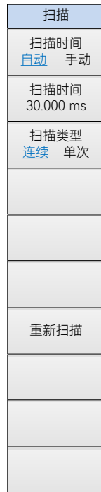
图 10.9 实时频谱模式扫描菜单结构框图
